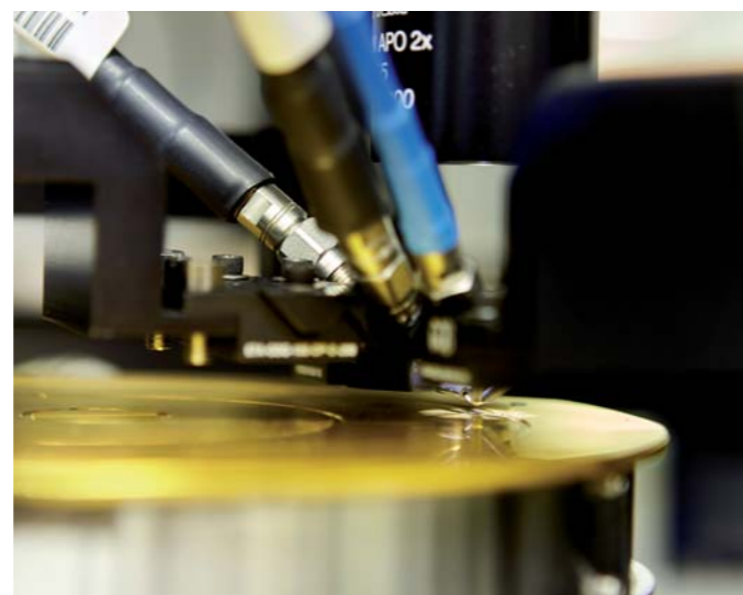
Extrem dünne Testspitzen und spezielle Kabel, um den Kontakt zwischen Messgeräten und Chip herzustellen. (© Universität Paderborn, Judith Kraft)
