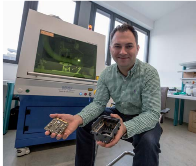
Die Funktionen auf der sperrigen Leiterplatte (links) werden im Fraunhofer IEM direkt ins Gehäuse des Gerätes (rechts) gebracht. Christoph Jürgehake arbeitet an der Weiterentwicklung der Technologie (© David Gense).
